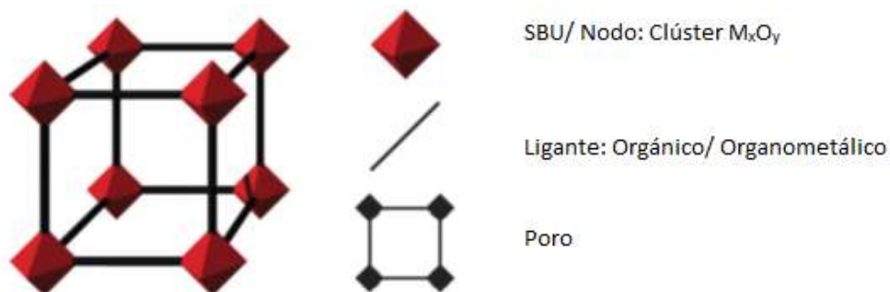
Figura 1. El nodo inorgánico (SBU) y el ligante orgánico son los componentes básicos de un MOF. Estos pueden ser variados y modificados post-sintéticamente para obtener estructuras con diferentes tamaños de poro, conectividad y funcionalidad química, convirtiéndolos en candidatos ideales para sistemas diseñados en la separación de agua. Modificado de (Meyer, Ranocchiari y Bokhoven) 11
