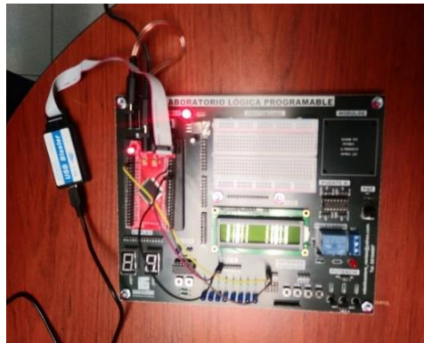
Figura 6. SBR para SSDRUP embebido en la FPGA EP2C5T144C8
