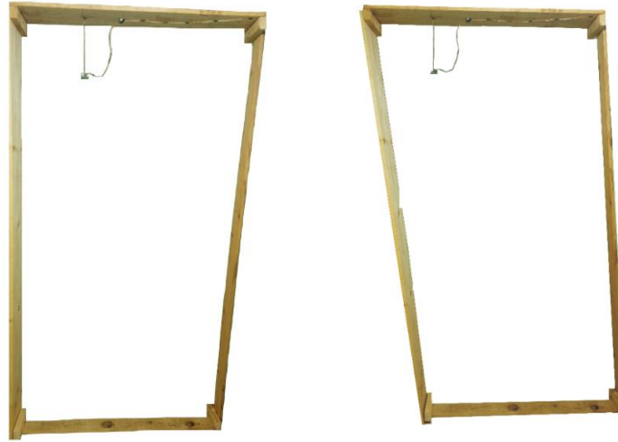
Figura 5. Instrumentación del modelo con sensores HC-SR04
