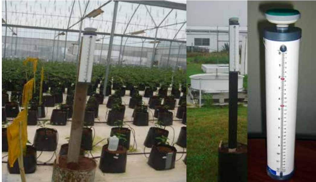
Fig. 2 Instalación del Atmómetro en el interior del invernadero.
