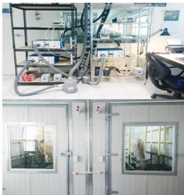
Figura 4. Equipo de medición de emisiones de metano y cámaras de respiración de circuito abierto de la FMVZ-UAEMex.
