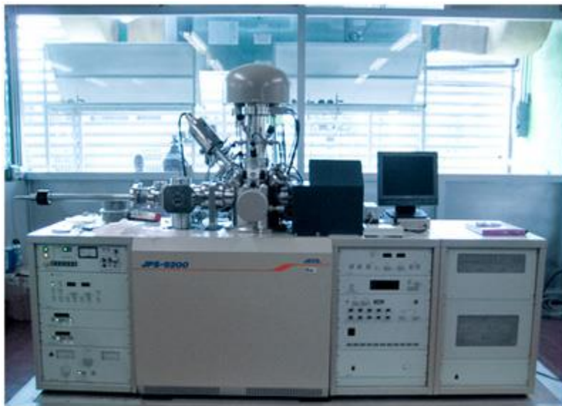
Figura 1.2.4. Espectroscopio fotoelectrónico de rayos X .
