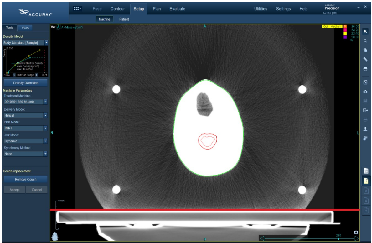
Figura 4.7: Esquema del posicionamiento de la camilla, delimitada por la línea roja para el reconocimiento del sistema.
