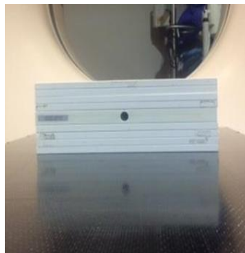
Figura 27. Arreglo de agua sólida TC.
