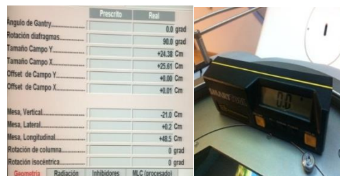
Figura 18. Nivel en el gantry y pantalla del acelerador.
