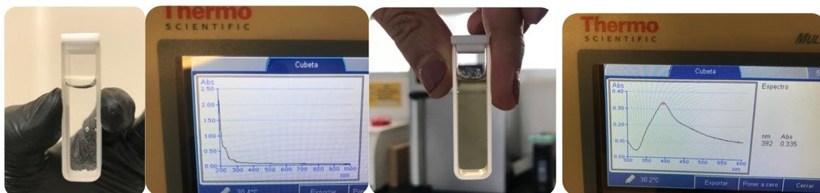
Fig. 3.- Caracterización de ZnO y AgNPs por espectrofotometría UV-vis.
