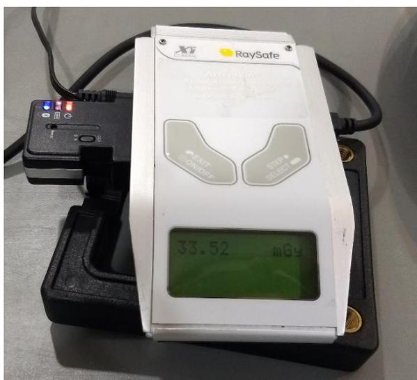
Figura 10. Electrómetro RaySafe Xi.
