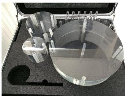
Figura 7. Maniqués cilíndricos de PMMA (modelo 76-419-4150, Fluke Biomedical).
