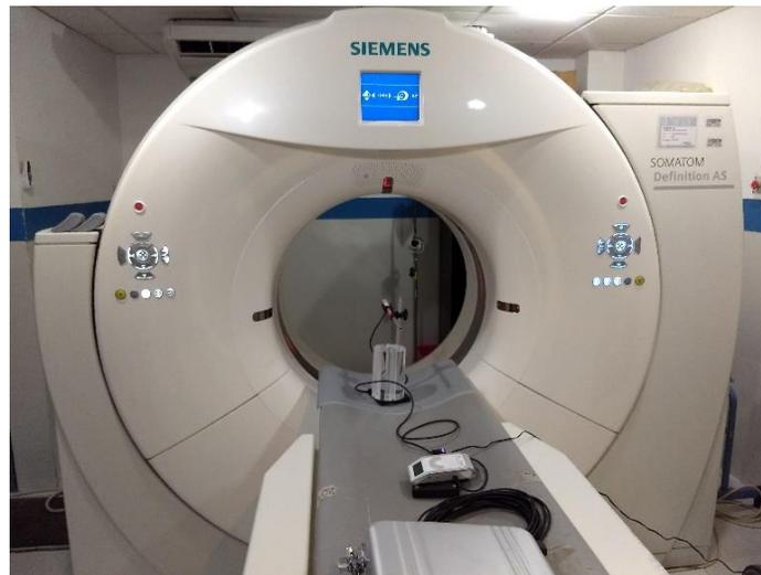
Figura 9. Posicionamiento de la cámara de ionización.
