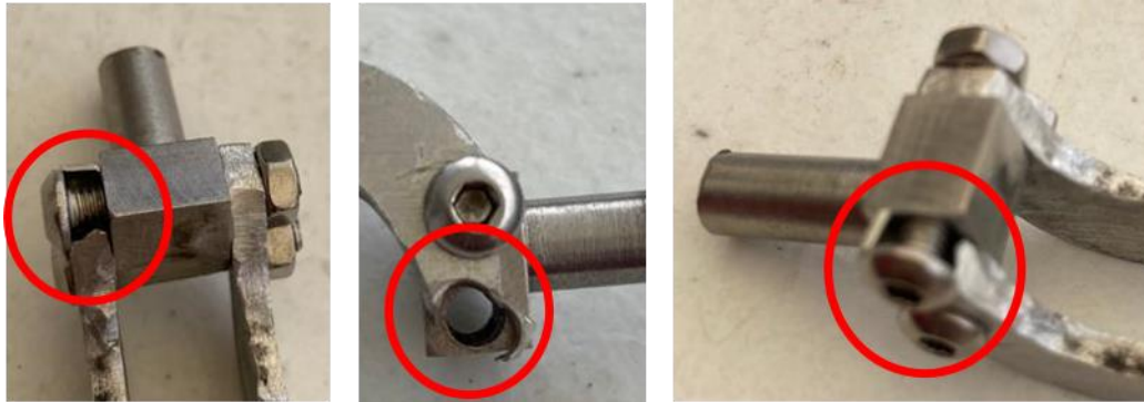
Figura 70. Falla localizada en el mecanismo de movimiento y bloqueo.
