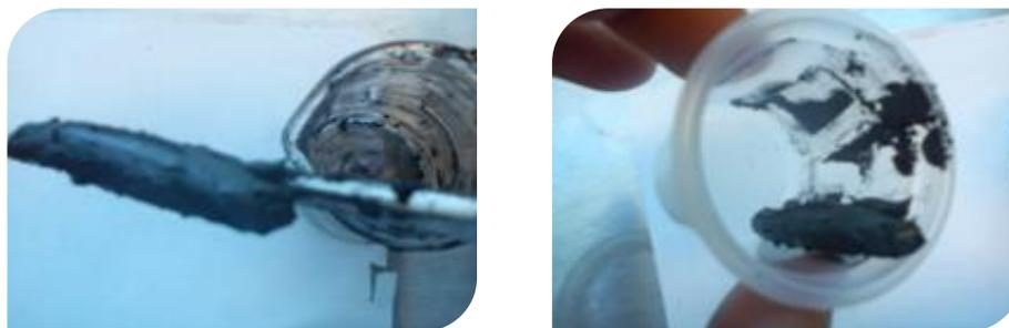
Figura 2.3. Para electrodos de pasta de carbono y composite, los componentes se mezclan hasta tener una pasta homogénea, importante para poder tener resultados reproducibles.
