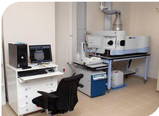
Figura 1.4. Espectrofotómetro de emisión óptica con plasma de acoplamiento inductivo de Perkin Elmer.
