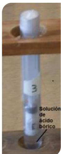
Figura 2.6. Sistema de condicionamiento de electrodo en solución de boro, durante un tiempo determinado.
