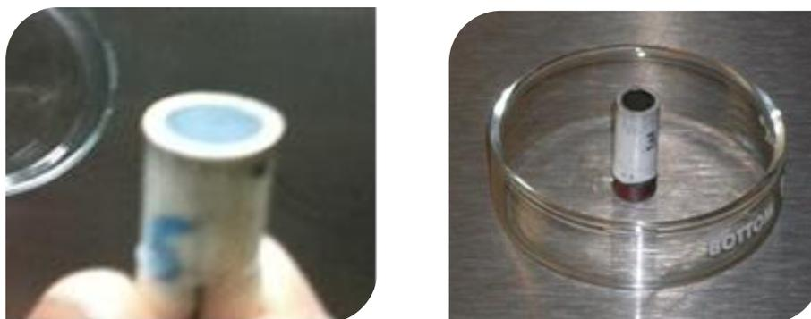
Figura 2.6. Se aplica capa de glutaraldehído al 1 % sobre superficie de trabajo de electrodos.
