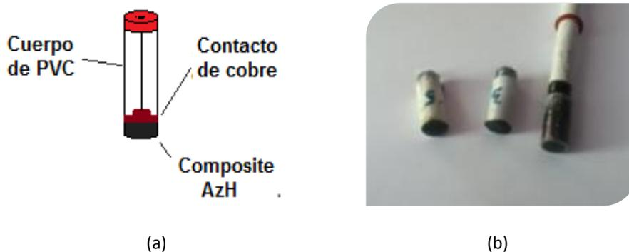
Figura 2.5. Esquema electrodos composite de azometina-H (a) y electrodos composite 3 % y 5 % (b)
