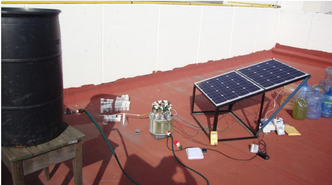
Figura 25. Sistema de la prueba de electrocoagulación-producción de hidrógeno.
