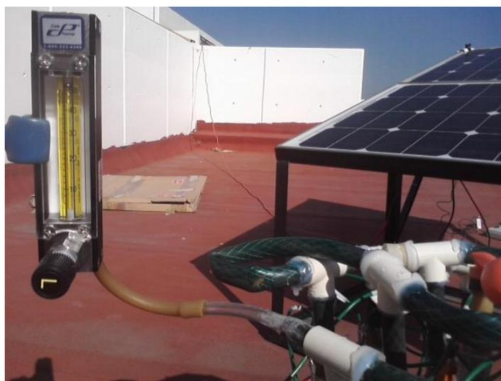
Figura 65. Fotografía del flujómetro conectada a la salida del reactor.
