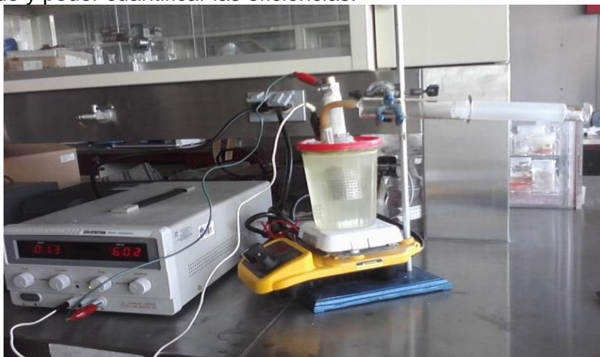
Figura 21. Fotografía del sistema de electrocoagulación.
