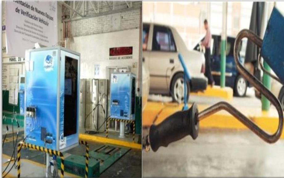
**Figura 2.10** Analizador de gases del verificentro
