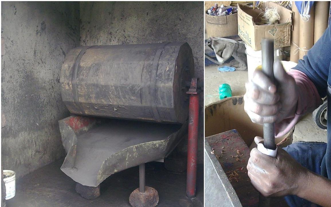
Figura A3. Barril de elaboración de pólvora (molino de bolas) y compactación de material.
