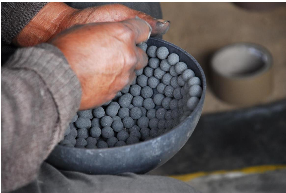
Figura 4.9. Elaboración de bombas pirotécnicas.
