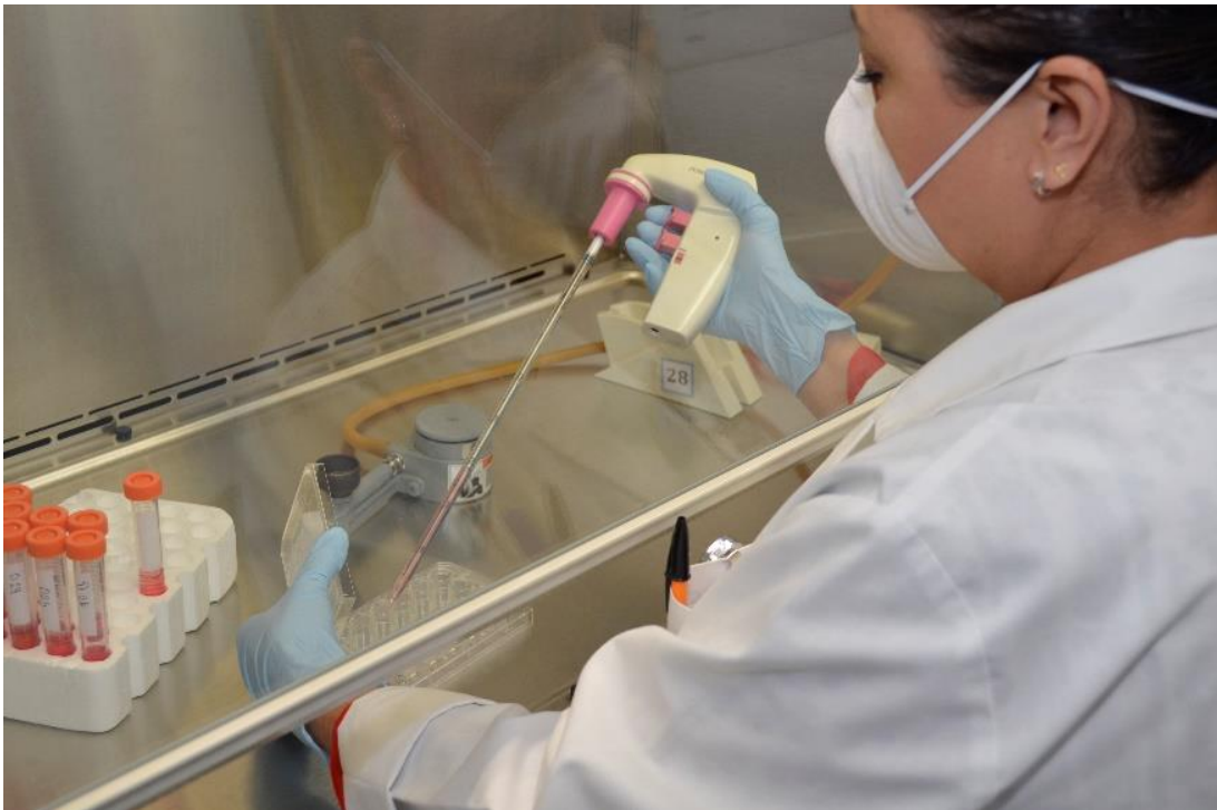
Trabajando con una campana de flujo laminar la cual permite tener una zona estéril en la realización de algunos procesos para evitar que se contaminen las muestras. (FMVZ-UAEM, 2017)
