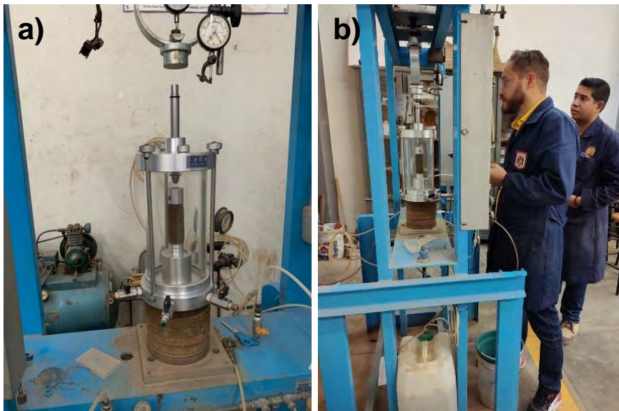
Figura 62. Prueba a compresión (a) y registro de resultados en prensa (b).
