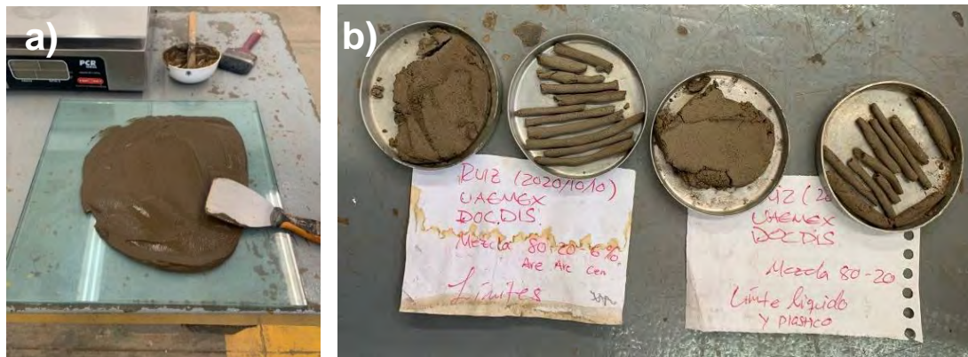
Figura 53. Mezcla (a) para prueba de plasticidad por rollo (b).
