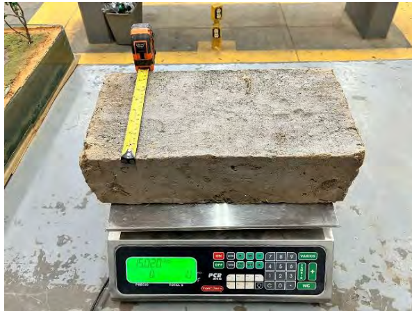
Figura 71. Pesaje y medición de bloques de adobe.
