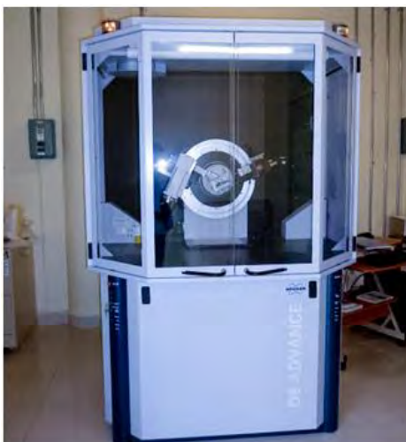
Figura 70. Difractómetro de rayos X, Bruker D8.
