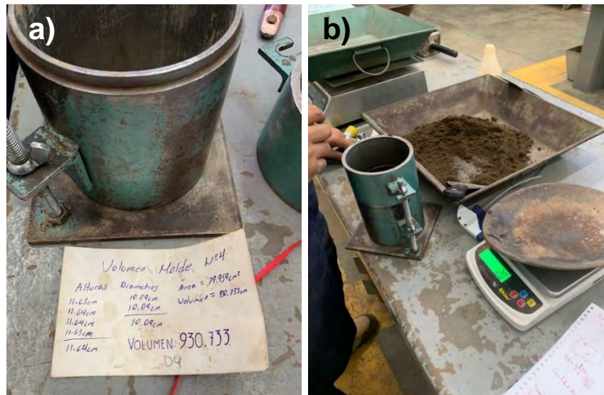
Figura 57. Molde (a) y preparación de muestra para moldeo (b).
