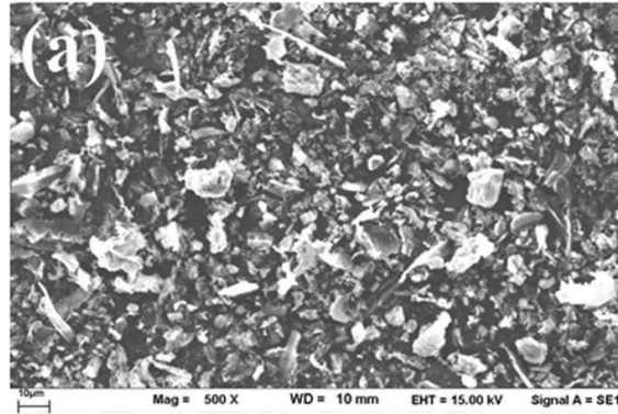
Figura 108. Microscopía de ceniza de bagazo de caña: aumento x 500 a 10µm.
