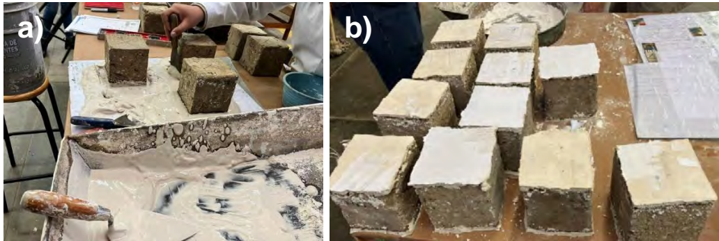
Figura 74. Mezcla de yeso (a) y cubos cabeceados (b).
