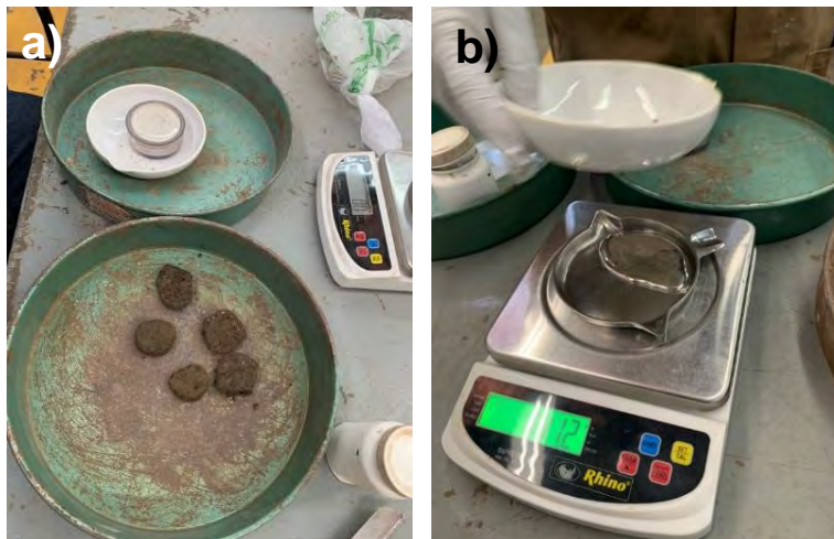
Figura 56. Terrones a prueba (a) y mercurio desalojado (b).
