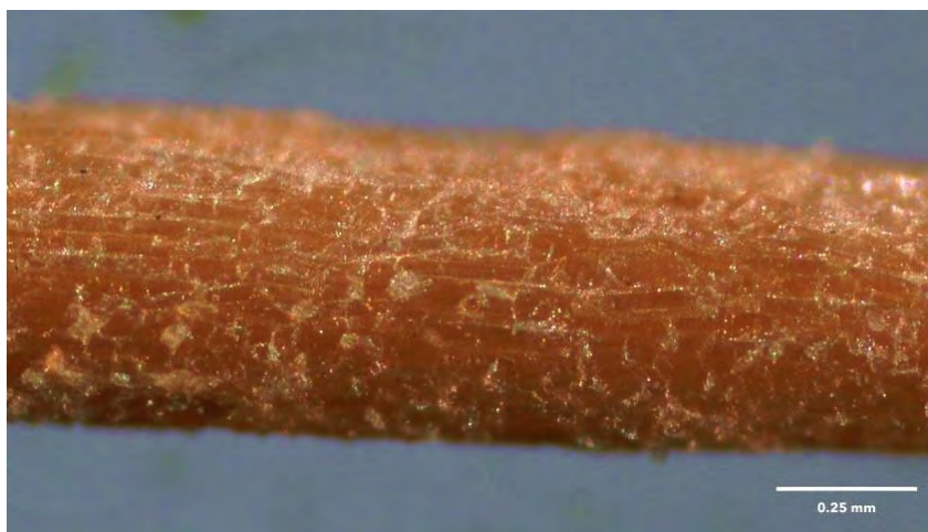
Figura 79. Microscopía de fibra de bagazo de agave (0.25mm).
