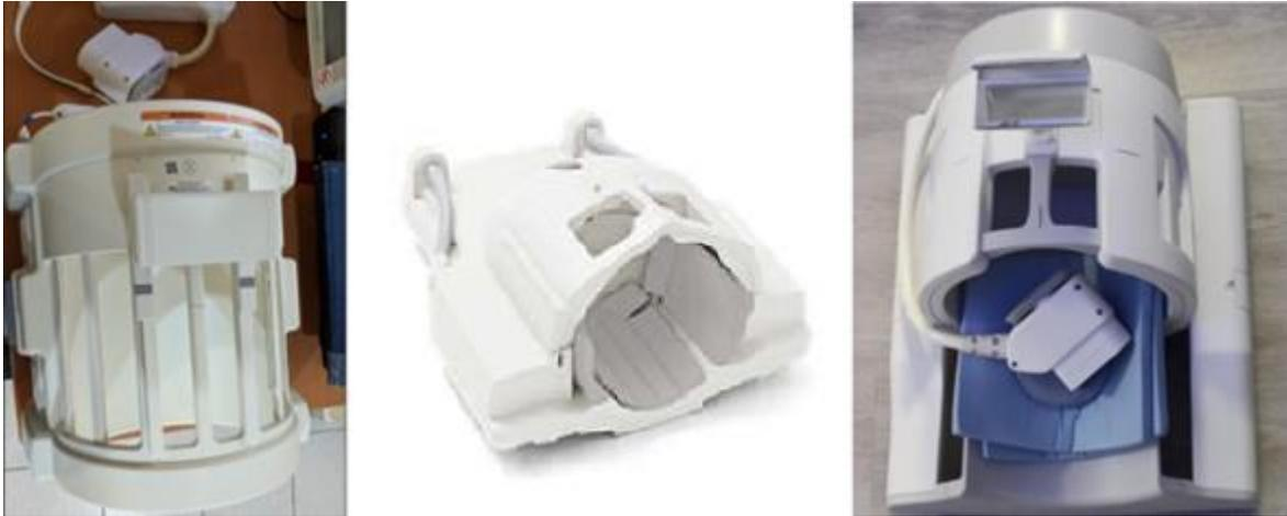
Figura 25. De izquierda a derecha: Antena de cuadratura GE, antena de cabeza PHILIPS, antena de cabeza GE.
