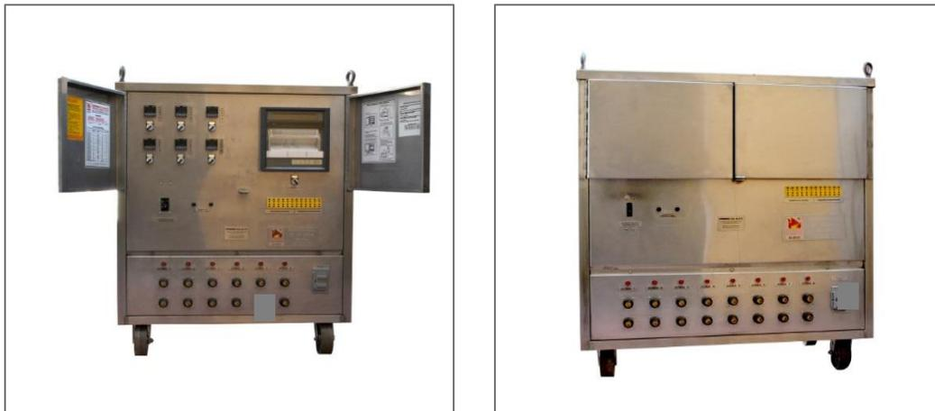
El relevado de esfuerzos es un proceso cuyo objetivo es liberar las tensiones residuales generadas por diversos procesos de manufactura, como maquinados profundos, forja o soldadura.
