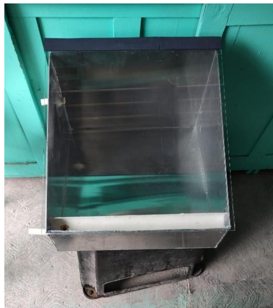
Figura 2.3. Ensamble del destilador solar de una sola pendiente Fuente: Imagen propia, 2020
