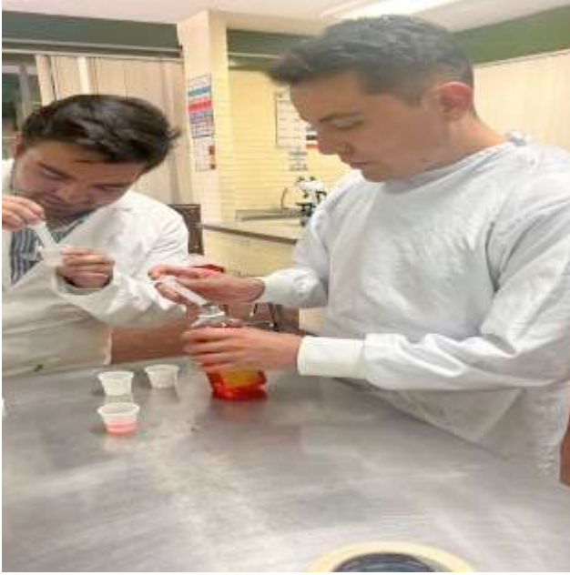
Imagen 6: Se colocaron 5 ml. de cada enjuague junto con 5 ml. De agua desionizada y se mezclan hasta su integración.
