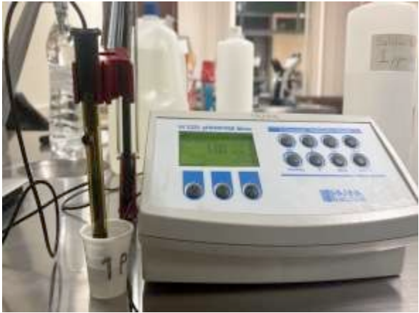
Imagen 3: Calibración del Potenciómetro con la solución TISAB II y muestras de fluoruro en sus diferentes concentraciones.
