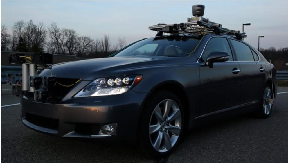
Figura 15. Auto Lexus Ls Sedan con sensores frontales y cámara de largo alcance para detectar obstáculos (<https://www.carscoops.com/2013/01/toyota-believes-in-driver-assistance/>)
