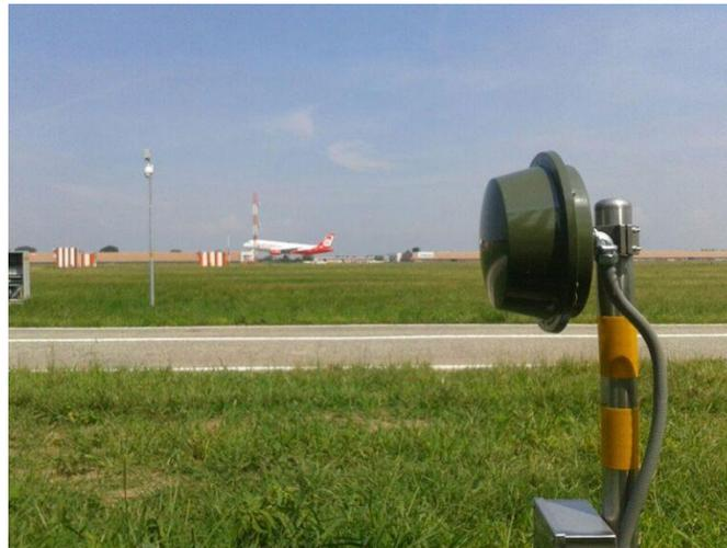
Figura 19. ERMO 482X PRO dispositivos de barreras de microondas con algoritmo de lógica difusa (<https://www.sicuralia.com/barreras-de-microondas-cias-serie-ermo-482x-pro/>)
