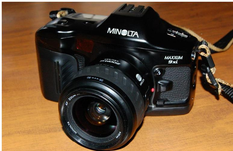
Figura 12. Cámara Minolta 9xi con implementación de lógica difusa en el encuadre de objeto y autoenfoco (<https://cameragx.com/2017/09/22/minolta-9xi-a-fuzzy-logic-camera-for-the-pros/>)
