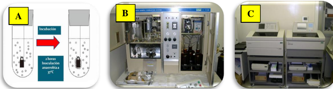
Figura 4. A) Imágenes del procedimiento experimental. B) Máquina de combustión (ACS-113B Hitachi-Aloka, Tokyo, Japan). C) Máquina de centelleo (LSC-900, Aloka, Tokyo, Japan).
