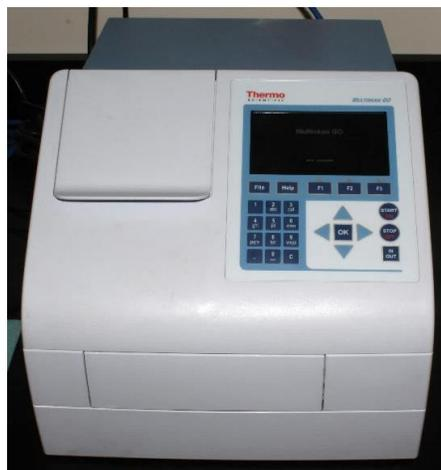
Fig. 10. Espectrofotómetro para medir la absorbancia. Fuente: propia.
