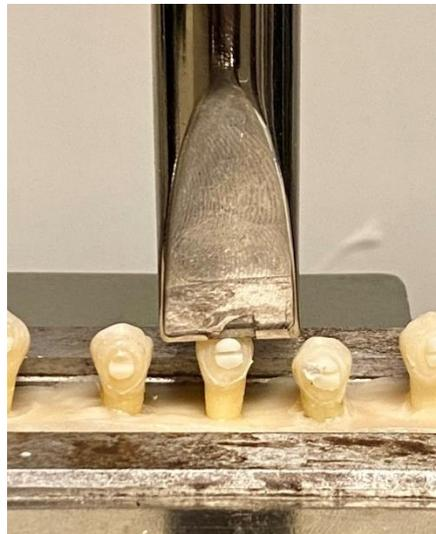
**Fig. 12.** Prueba de resistencia al descementado. **Fuente:** propia.
