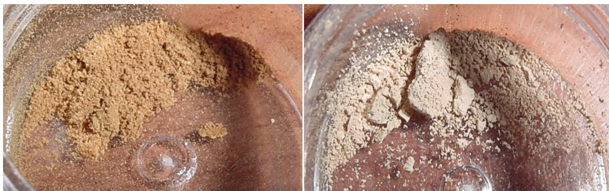
Figura 3.10. Polvo obtenido a) PEG/PPy/I 40 W, b) PEG/PPY/I 100 W.
