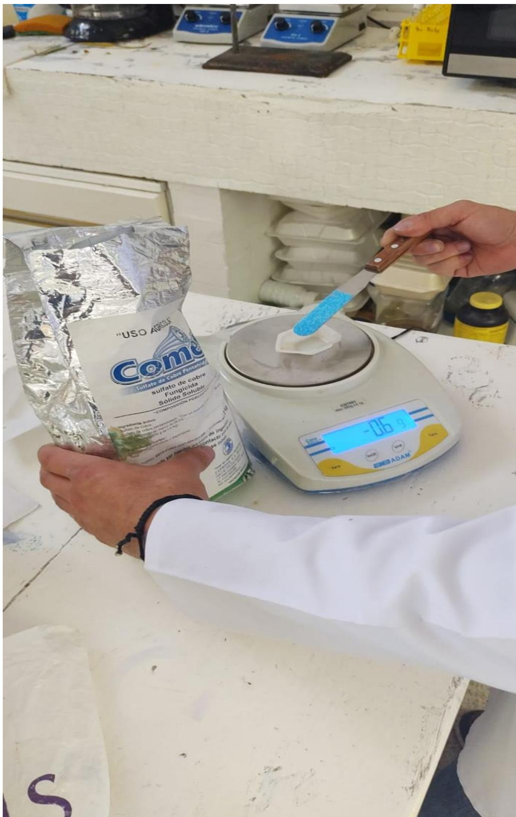
ANEXO.10.-Pesado de sulfato de cobre pentahidratado
