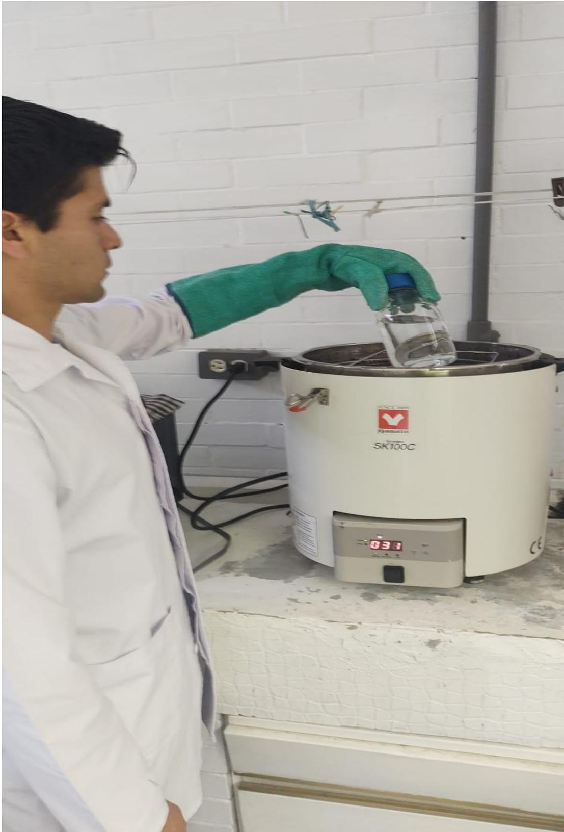
ANEXO 6.-Retirando frasco estéril con agua destilada del autoclave
