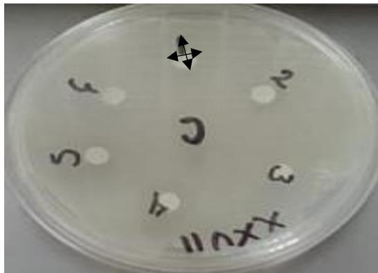
**Figura 5** Medición del halo de inhibición pasados 24hrs. del tratamiento.
