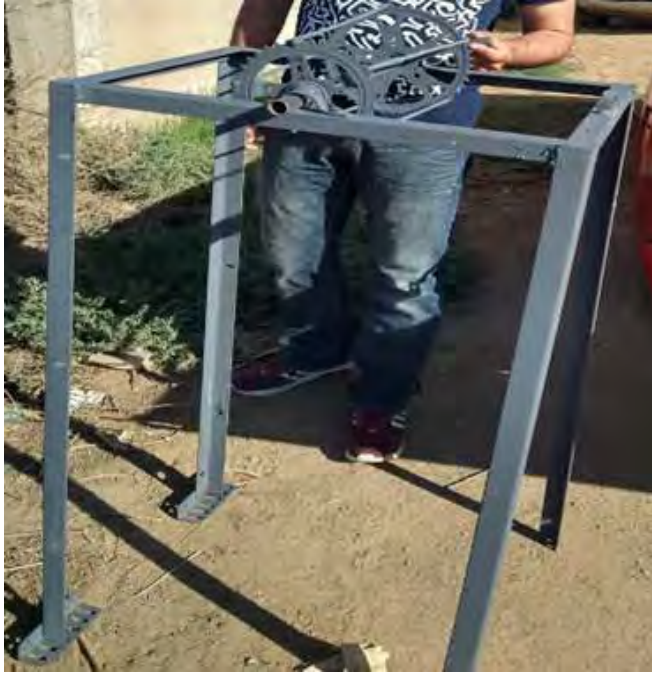
Figura 8. Ensamblado del mecanismo de enrollador de alambre acerado.
