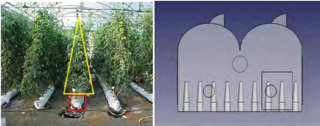
Figura 4. Simplificación de geometría para las plantas, modelo CAD con plantas y ventilación forzada.
