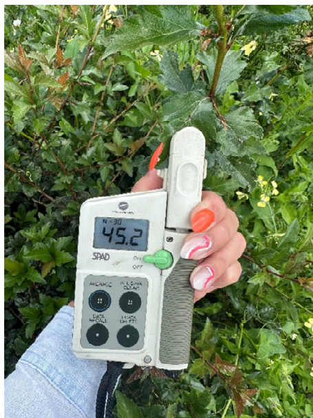
Figura 6. Toma de lectura del verdor foliar de tejocotero con el medidor SPAD.
