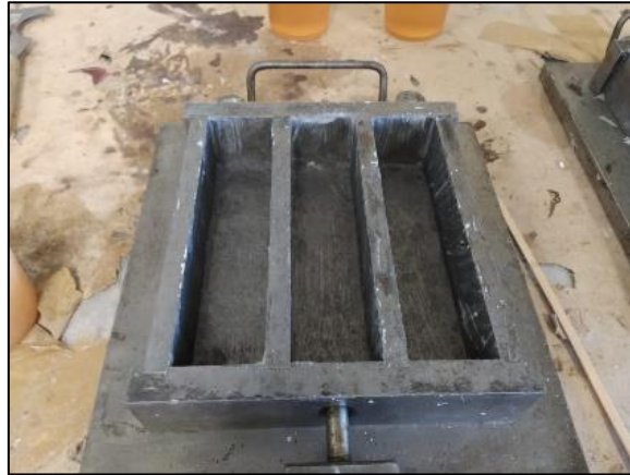
Figura 2.5. Molde para la preparación de las probetas de concreto
