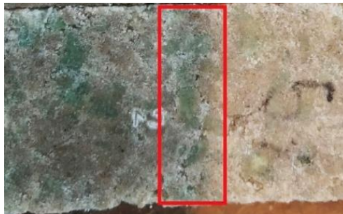
Figura 3.9. Concreto con 5% de fibras de PET, después del ensayo de flexión.
