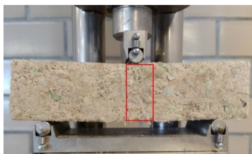
Figura 3.6. Fractura del concreto con 5% de fibras de PET, después del ensayo de flexión.
