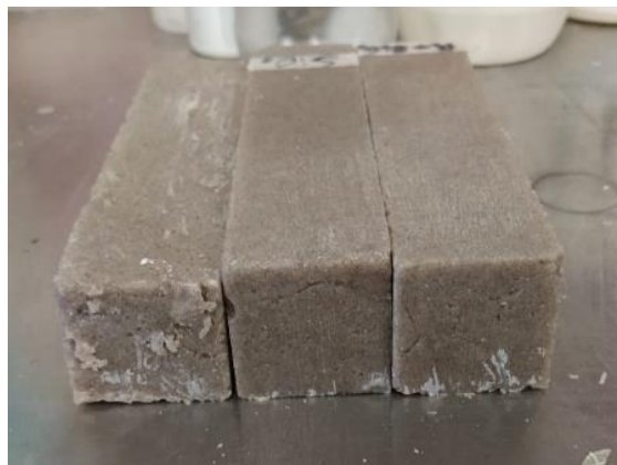
Figura 2.8. Probetas de concretos poliméricos.
