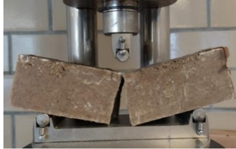
Figura 3.2. Fractura del concreto control durante el ensayo de flexión.
