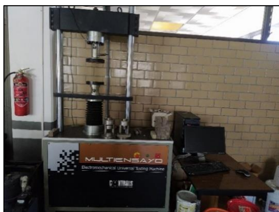
Figura 2.9. Máquina Universal utilizada para los ensayos de flexión y compresión.
