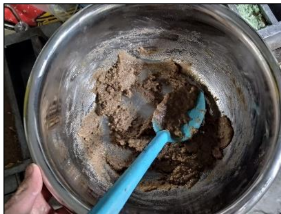
Figura 2.6. Preparación de los concretos poliméricos
