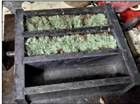
Figura 2.7. Mezclas de resina poliéster, arena de sílice, nanosílice y fibra de PET
