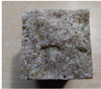
Figura 3.5. Superficie de fractura del concreto con 3% de hojuelas de PET, después del ensayo de flexión.
