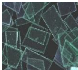
Figura 3.12. Microscopia óptica de las hojuelas de PET.
