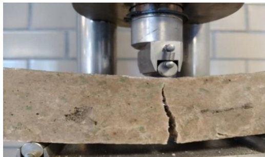
Figura 3.4. Fractura del concreto con 3% de hojuelas de PET, después del ensayo de flexión.
