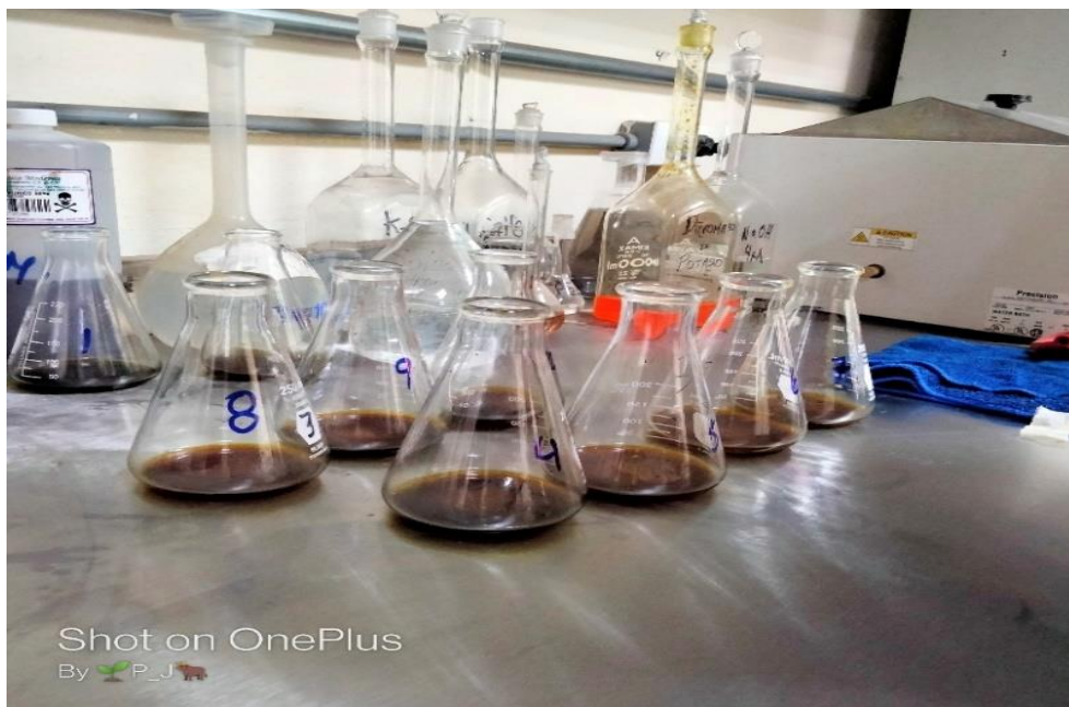
Ilustración 21 Muestras con dicromato de potasio y ácido sulfúrico
