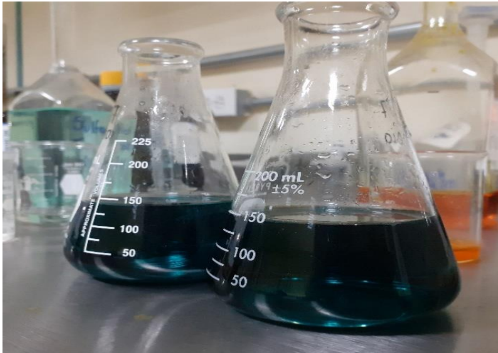
Ilustración 23 Muestras tituladas con sulfato ferroso
