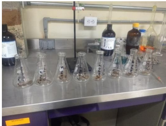
Figura 10 Pesaje de 0.5 gr de muestra tamizada y colocada en matraz Erlenmeyer
