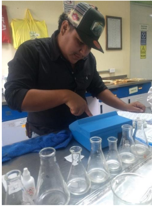
Figura 7 Agitación del reactivo de fósforo para lectura de fotómetro
