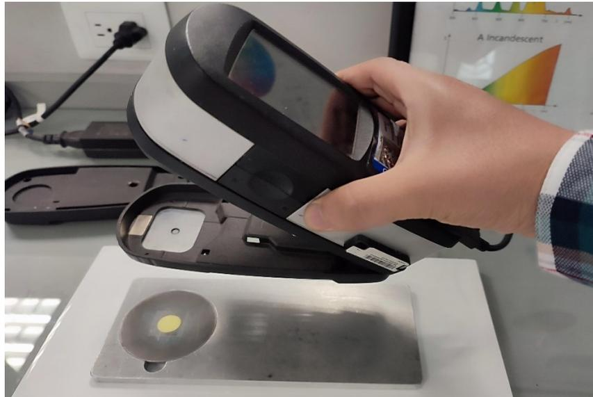
**Figura 5.6** Forma de medir una dilución de color con el espectrofotómetro
