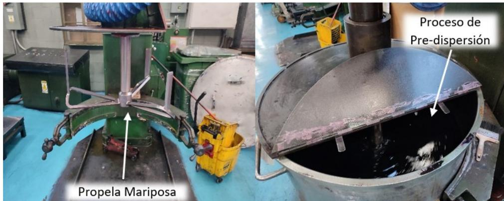
**Figura 5.4** Área de pre-dispersión y mezclado de la planta NW en Siegwark México, 2022
