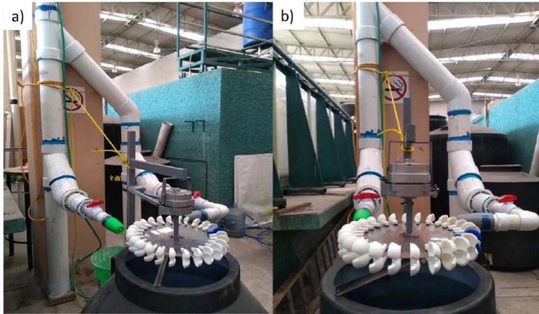
Figura 1. Instalación del modelo físico de experimentación de la turbina y la bajada de lluvia: a) vista isométrica y b) frontal Fuente: (Zamora, 2019)
