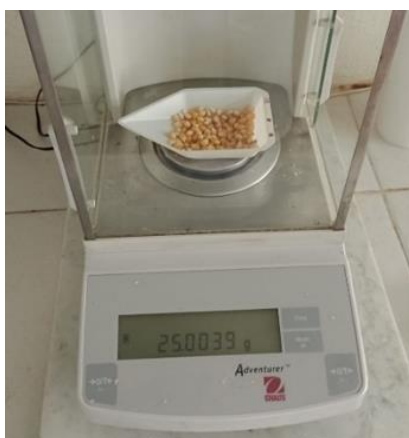
Figura 5. Peso de 25 g de muestra de maíz híbrido en balanza analítica.
