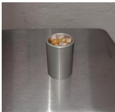
Figura 8. Determinación del peso hectolitro en granos de maíz.
