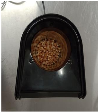
Figura 9. Granos de maíz palomero (25 g) en el interior de la cámara de reventado de la palomera.
