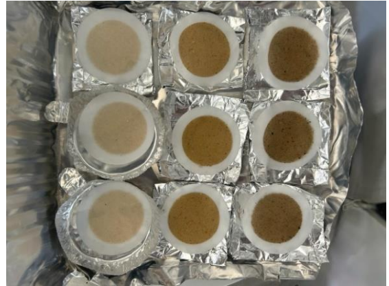
Figura 3.7. Ejecución de método gravimétrico A) Equipo de filtrado del laboratorio de calidad del agua del IITCA, B) Filtros con material retenido
