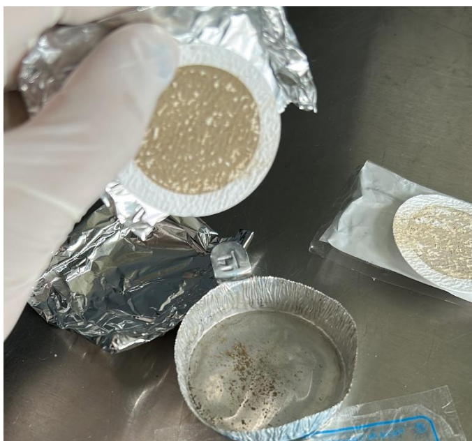
Figura 3.5. Material adherido a filtro de fibra de vidrio después de ser filtrado Whatman GF/F, tamaño de poro igual a 0.7 \mu\text{m}
