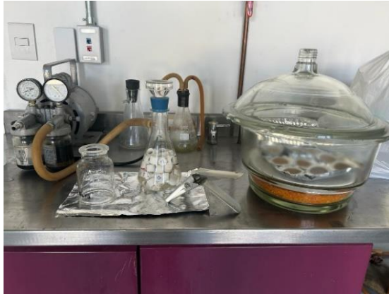
Figura 3.7. Ejecución de método gravimétrico A) Equipo de filtrado del laboratorio de calidad del agua del IITCA, B) Filtros con material retenido
