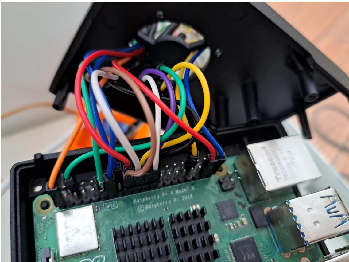
**Figura 4.6** Conexiones de la Raspberry Pi. Se muestran las distintas conexiones que se emplearon en la RaspberryPi, desde las comunicaciones SPI con las tarjetas RFID, los servomotores hasta los botones de activación.
