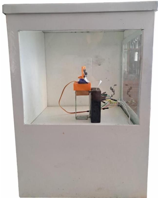
**Figura 4.7** Caja protectora con cámara y RaspberryPi. Se muestra la caja protectora con los dos cristales que permiten que la cámara pueda tener la visión hacia ambos sentidos, junto con la RaspberryPi y una carcasa. Todo esto sostenido por la base diseñada. (Elaboración propia)
