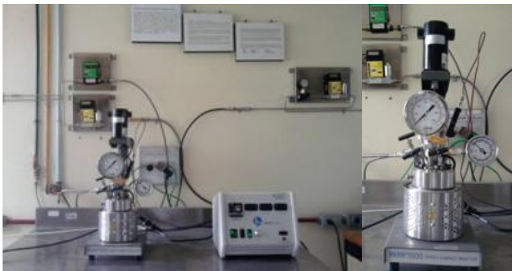
Figura 11 Reactor por lotes del laboratorio de reactores de ingeniería química de la Facultad de Química de la Universidad Autónoma del Estado de México (UAEM)
