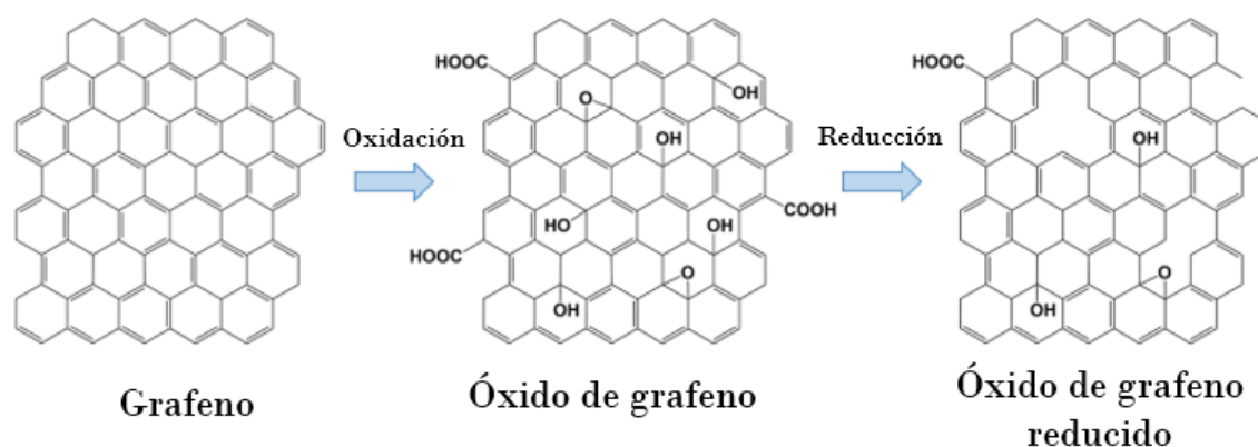
Figura 3. Estructura del grafeno, óxido de grafeno y óxido de grafeno reducido.
