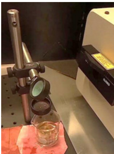
Figura 21. Configuración experimental para la obtención de AgNPs a través de LAL
