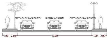
Esquema 6 - Corte Topográfico Av. Morelos (2. Vialidad Principal) - Jiménez / 2023 - Fuente: Elaboración Propia
