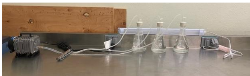
Figura d.1: Disposición del sistema de cultivo tipo batch.
