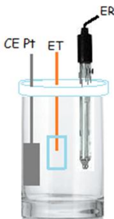
Figura 9. Sistema electroquímico empleado para la síntesis de \text{NP}_P y \text{NP}_L de ZnO.
