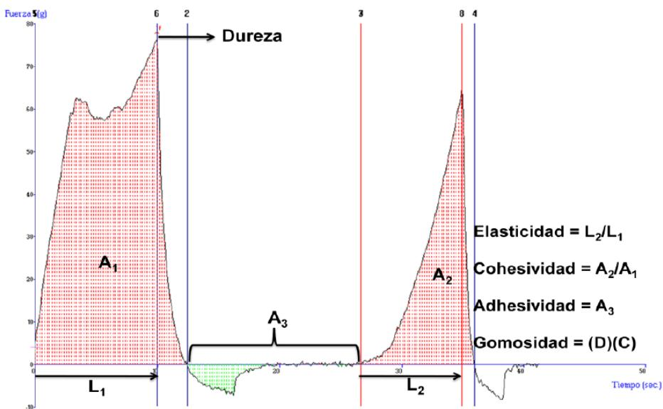
Figura 8. Curva típica del análisis de perfil textura (TPA)
