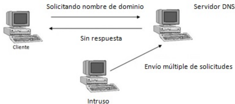
Figura 4.1: Esquema del ataque DoS
