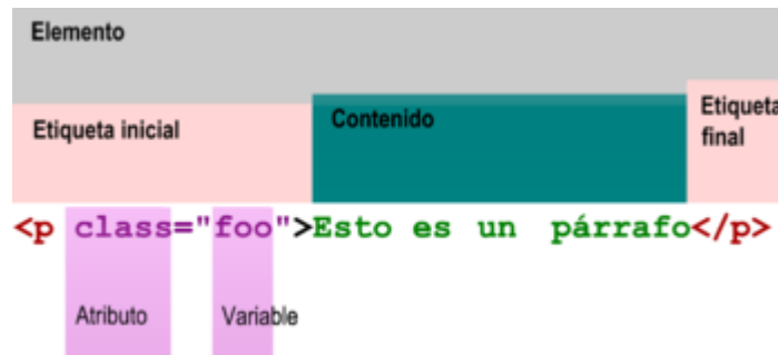
Figura 6. Estructura general de una línea de código en el lenguaje de etiquetas HTML.
