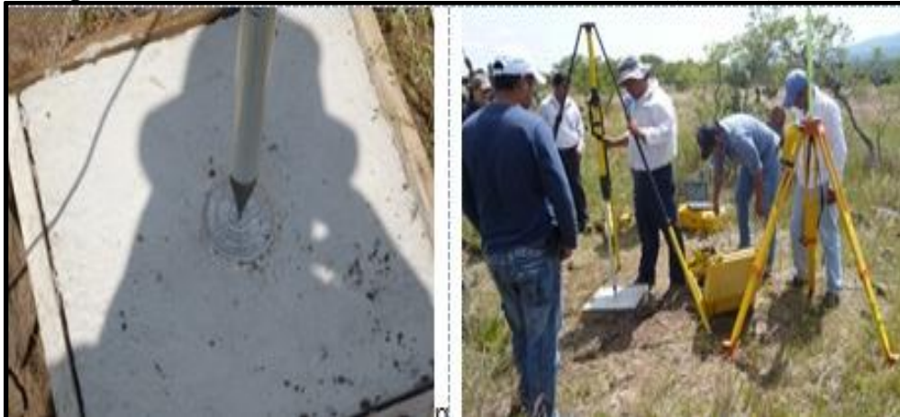
Fig. 2.15 Monumentación de Línea de Control Azimutal, Aculco, México
