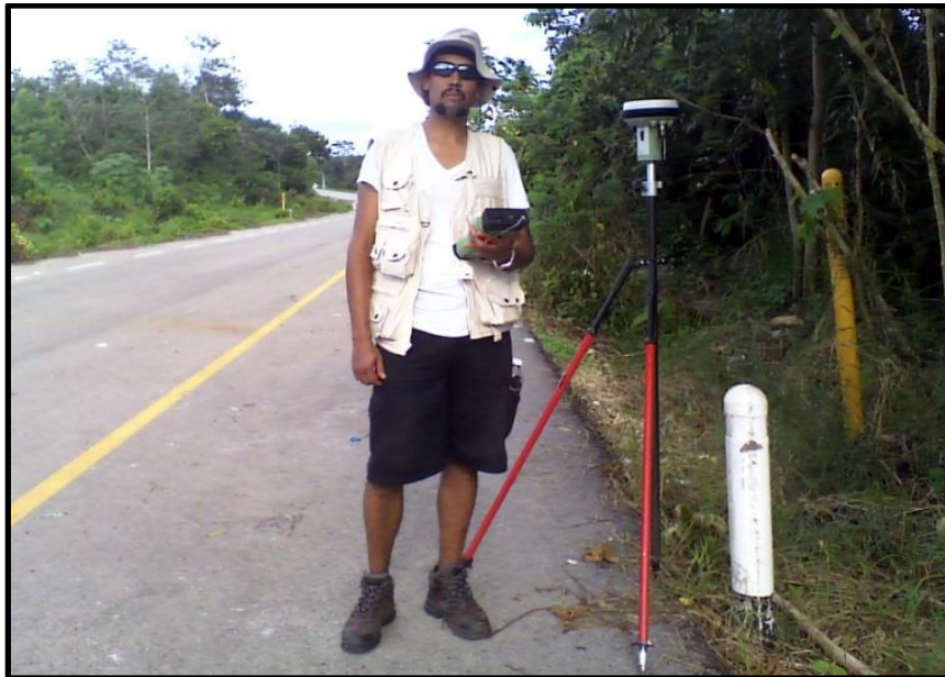
Fig. 4.11 Levantamiento en campo con equipo de medición GPS Leica Viva
