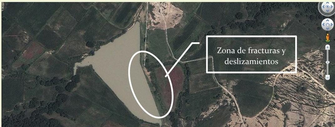
**Problemática:** En el mes de Septiembre la presa sufrió un desbordamiento hídrico sobre la cortina, la intensidad de la lluvia origino grietas en la corona del bordo que sustenta la cortina y origino deslizamientos sobre el talud del mismo.
