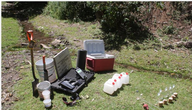
Una vez que se cuenta con estos datos, se determina el gasto del manantial mediante un proceso directo y con la aplicación de la fórmula  $Q = \text{Volumen} / \text{tiempo}$ .
