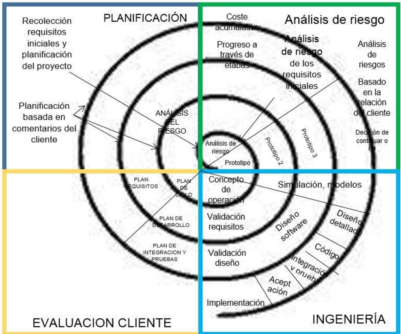
Figura No: 2 Ciclo de vida de un sistema, modelo de Boehm.
