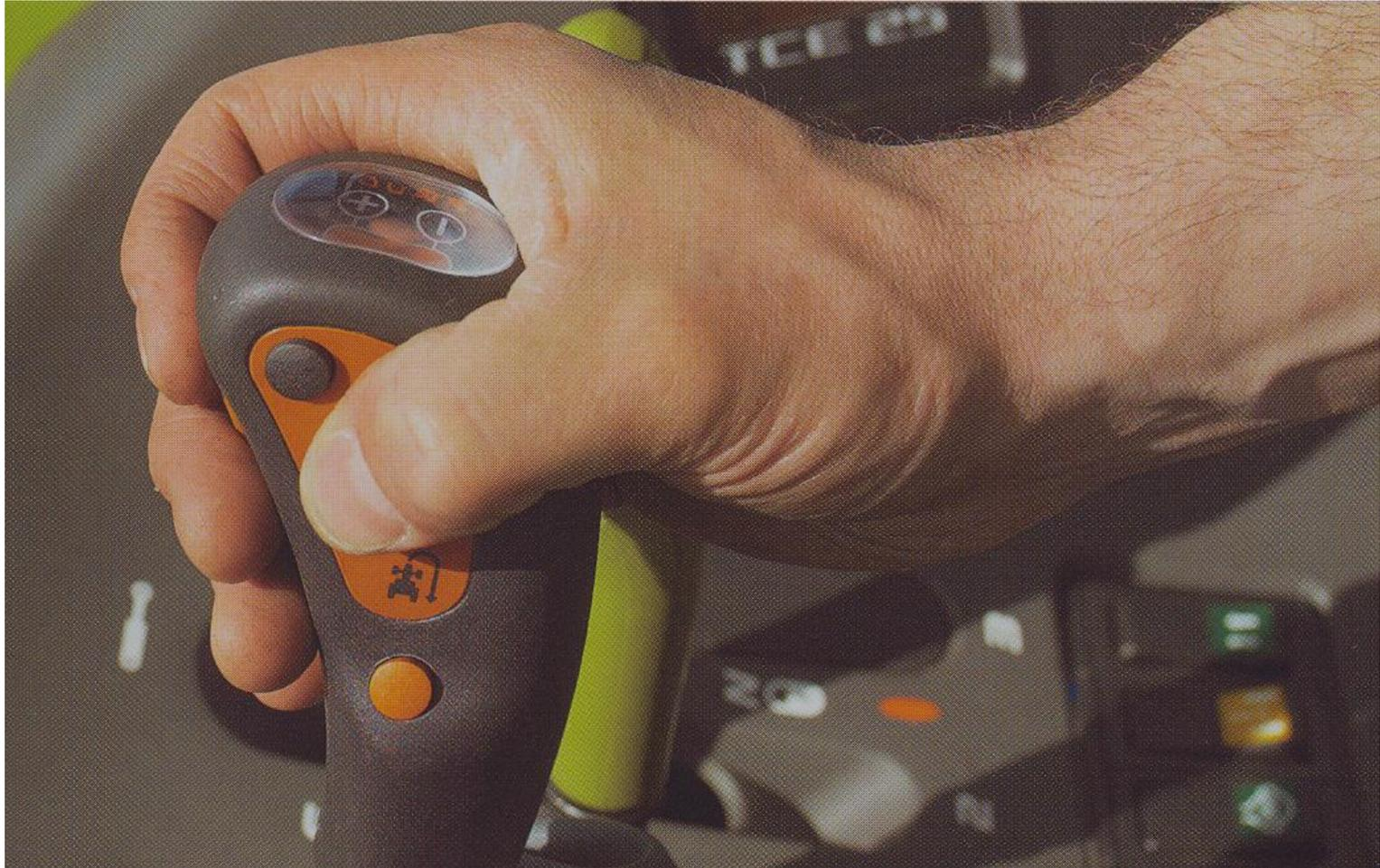
**PARA EL ENGRANAJE HIDRAÚLICO INVERSOR REVERSHIFT NO HACE FALTA GRAN ESFUERZO Y SI SOLO EL BREVE TOQUE DE UN DEDO PARA QUE EL TRACTOR CAMBIE SUAVEMENTE SU DIRECCIÓN DE AVANCE A CUALQUIER VELOCIDAD Y EN CUALQUIER MARCHA. ESTO AHORRA MUCHO TIEMPO Y AUMENTA SU RENDIMIENTO.**
