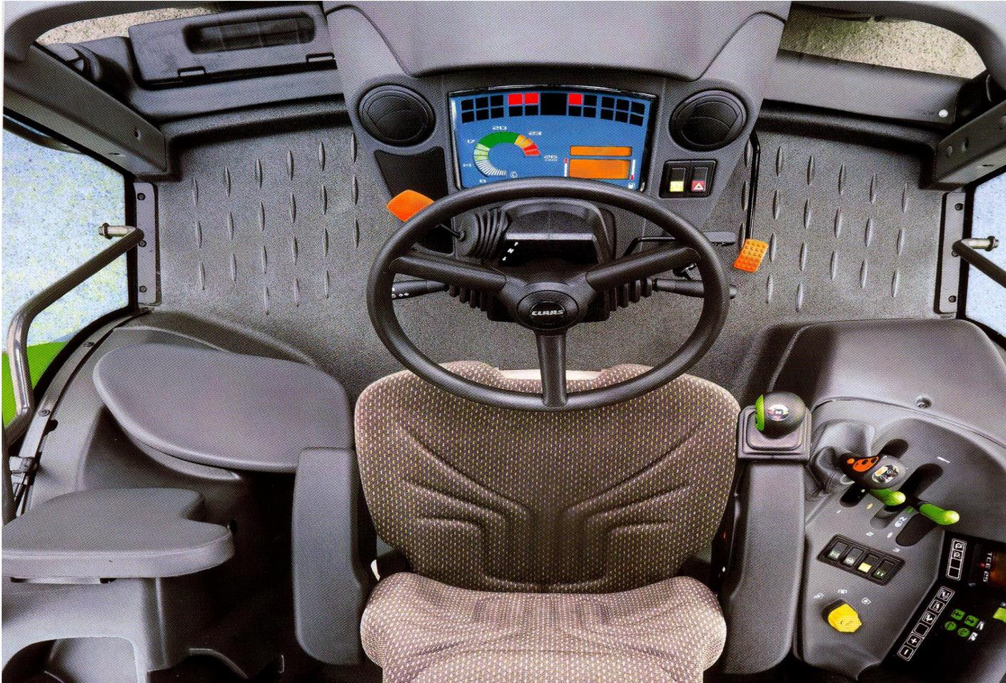
CABINA DE UN TRACTOR MODERNO VISTA DESDE ARRIBA Y EN ÉL SE COMBINAN LOS SIGUIENTES ELEMENTOS: ESPACIO ORDENADO, Y EXTRAORDINARIAMENTE CÓMODO, MÍNIMO RUIDO (POR TENER CABINA PRESURIZADA), VIBRACIONES DENTRO DE LOS RANGOS ESTABLECIDOS POR LAS NORMAS *ISO*. TODOS LOS ELEMENTOS PARA LA DIRECCIÓN Y MANEJO AL ALCANCE DE LA MANO O SEA ALREDEDOR DEL CONDUCTOR. LA BARRA DE DIRECCIÓN REGULABLE Y EL ASIENTO CONFORT DE AJUSTE EN CUATRO DIRECCIONES, LO CUAL PERMITE REGULARLO EN LA POSICIÓN ÓPTIMA.
