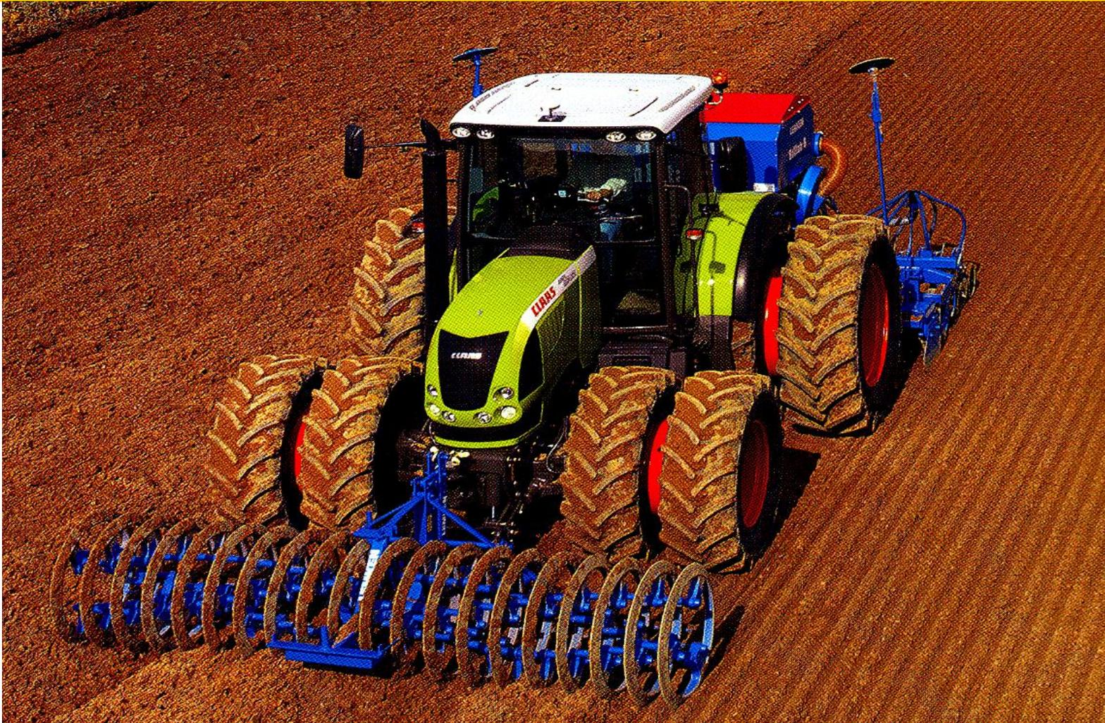
BAJO ESTE ESQUEMA DE DISTRIBUCIÓN DE LAS MÁQUINAS AGRÍCOLAS EN EL TRACTOR, SE FUNDAMENTA EN PARTE EL PRINCIPIO DE LA MECANIZACIÓN DE LA LABRANZA MÍNIMA DE SUELOS, YA QUE HAY UNA MENOR COMPACTACIÓN EN EL SUELO POR EL REITERADO TRÁNSITO DEL TRACTOR POR EL CAMPO DE CULTIVO.
