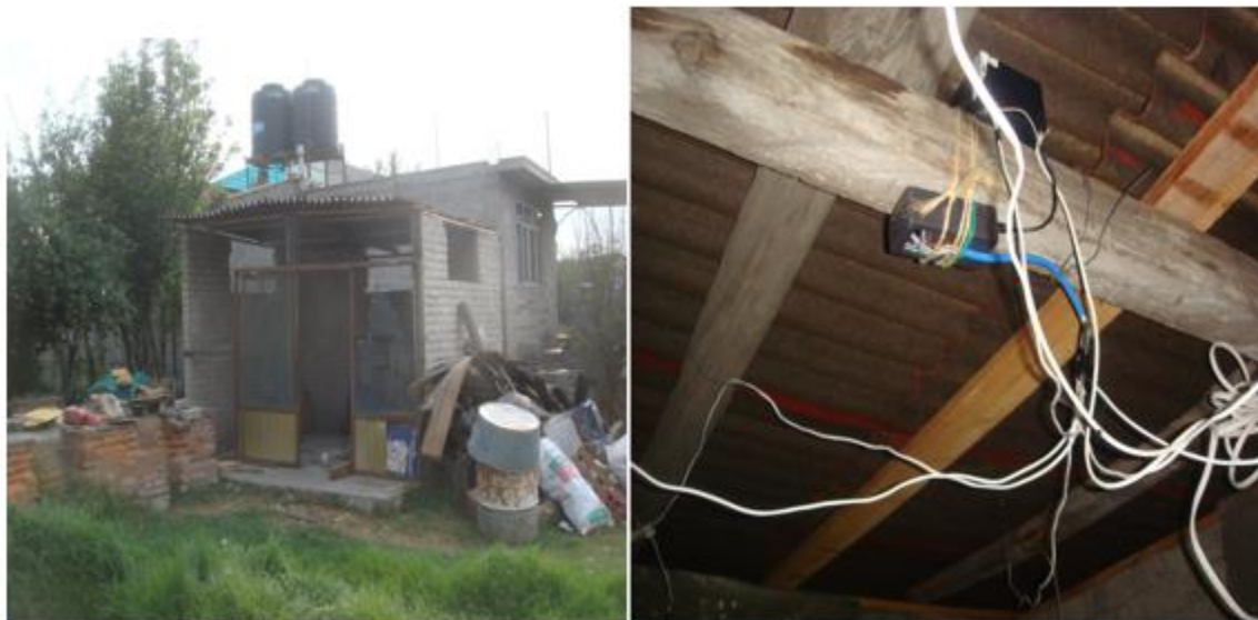
Figura 1 Instalación provisional de un sistema electrónico de captura de datos de temperatura humedad con un sistema Arduino
